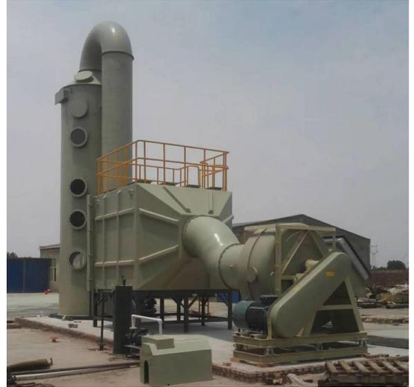
主结构体厚度根据各型号及处理量单独设计计算且具有足够补强，足以负担结构体及运转中所需之负荷、检视窗、采样口及循环液体、化学药液注入口及排水口配合机能设置，并提供必要之操作平台。
