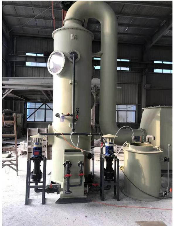
上，其材质同填充层材质耐蚀较佳之材质。洒水头采用 PP120 度旋转无堵塞喷头。为此，全系统具有极高的耐酸碱性能，全系统的阻力小于 50mmAq，大大节约了能源的消耗量。
